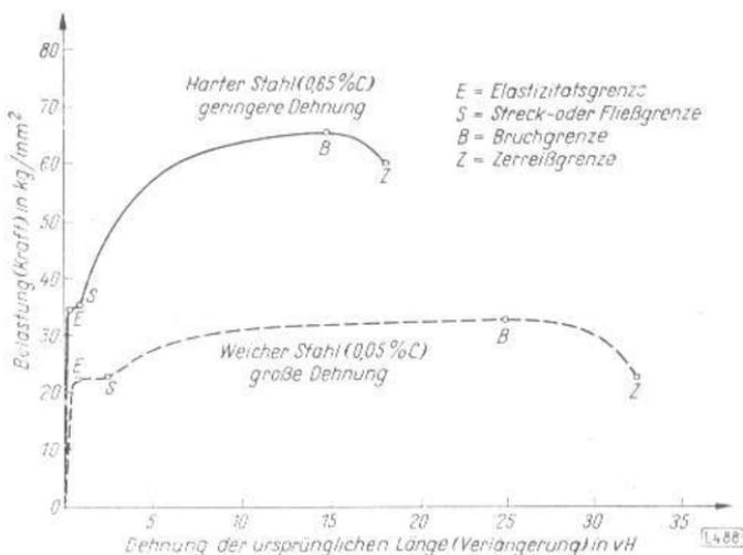
Bild 186 Kraftverlängerungs-Diagramm für Stahl
